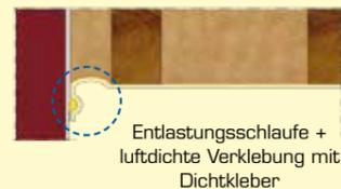
Entlastungsschleife + luftdichte Verklebung mit Dichtkleber
